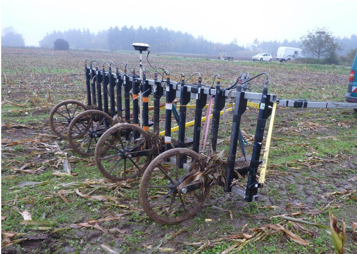
Beispiel einer geomagnetischen Aufzeichnung mittels DGPS-gestütztem 16-Vertikal-Gradiometern
